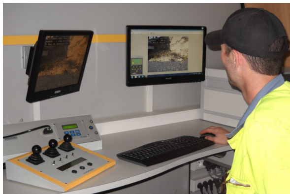
Exemple d'inspection télévisée avec véhicule spécialisé
