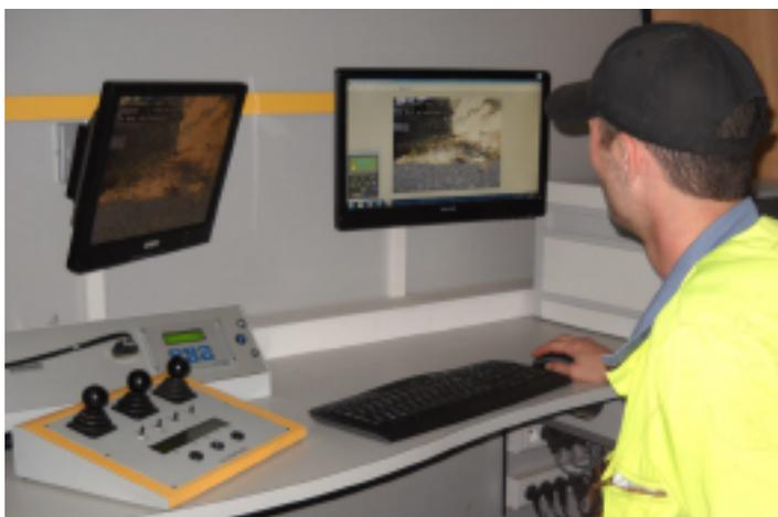
Exemple d'inspection télévisée avec véhicule spécialisé
